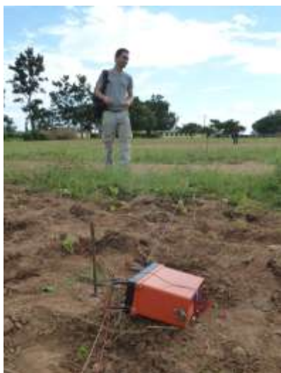
Figuur 2: Terrameter en metingen nabij het hek
