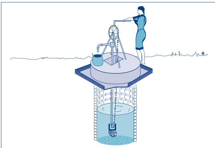
Fig. 9.12. Rope pump
