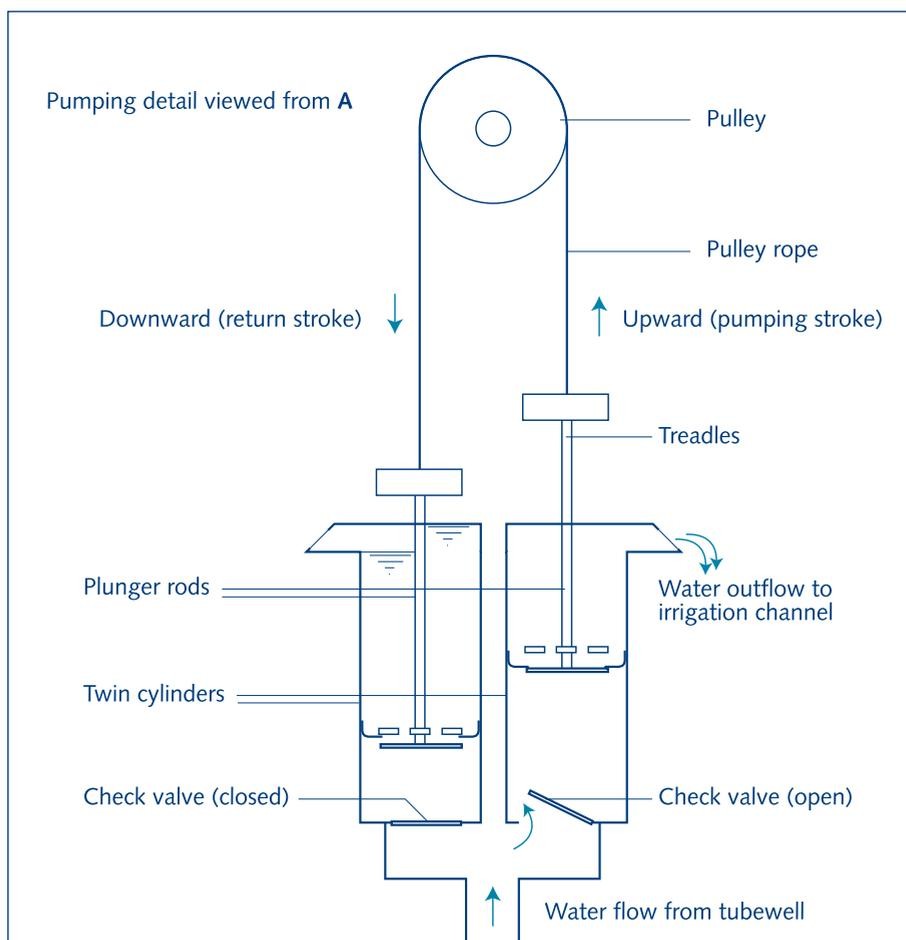
Fig. 9.5. Treadle pump
