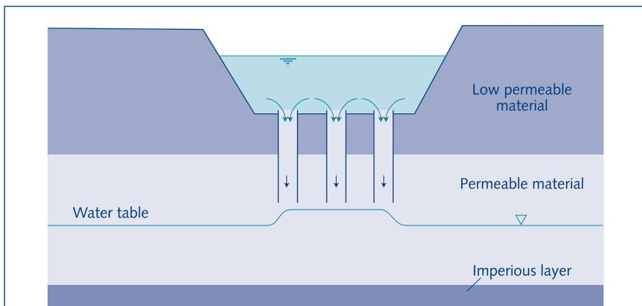
Fig. 6.12. Recharge shafts
